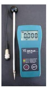
Per la misurazione di: - Salinità (AM) nel terreno/substrato
