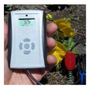
Per la misurazione di: - contenuto assoluto dell'acqua in un volume di terreno (%)
