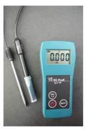
Per la misurazione di: - Conducibilità elettrica (EC) nei liquidi
