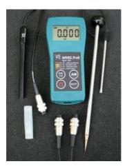
Per la misurazione di: - Conducibilità elettrica (EC) nei liquidi - Salinità (AM) nel terreno
